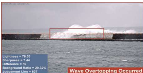
圖 3-35、港區防波堤越波影像判釋
