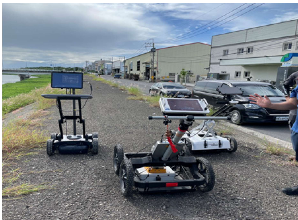
圖 1-34、透地雷達設備
